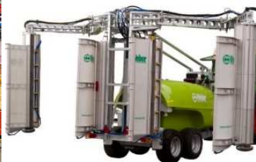
WEBER – descentes avec panneaux récupérateurs
