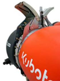
KUBOTA XTA22, XTA33 avec aileron anti-dérive
